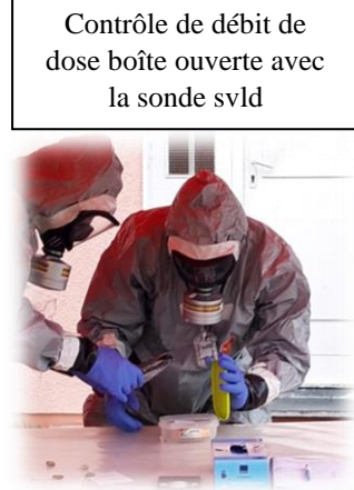
Contrôle de contamination au « quasi » contact avec le contaminomètre (Como)
