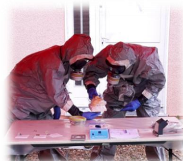
Contrôle de contamination au « quasi » contact avec le contaminomètre (Como)
